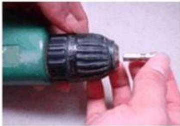
图 1 安装合适的螺丝批头
