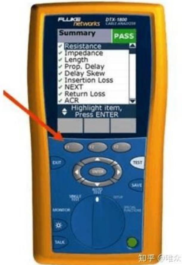
图 7 按故障信息键“F1 键”获取故障信息
