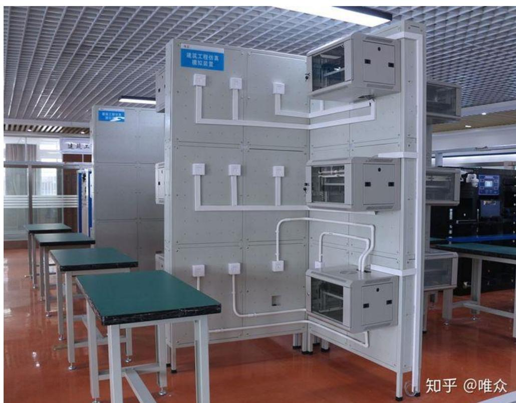
由多功能螺孔板组成,全钢结构仿真墙, 仿真墙采用全模块化(内不含木蕊板), 方便组装和实训(骨架连接不得采用铆钉)。每面墙工作面积宽不小于 1.2M, 高不低于 2.6M, 每个工位可以满足 4 个学生实训, 各子系统模块孔板采用简单、坚固、美观的固定方式, 方便模块更换, 真正做到一台多用。每个多功能网孔板尺寸不小于 758×556mm, 厚度不小于 1.5mm 组成, 模块化方便组装及实训教学;满足网络综合布线工程布线各个子系统实训功能, 具有同时或交叉进行网络综合布线工程布线系统工程七个子系统实训。
